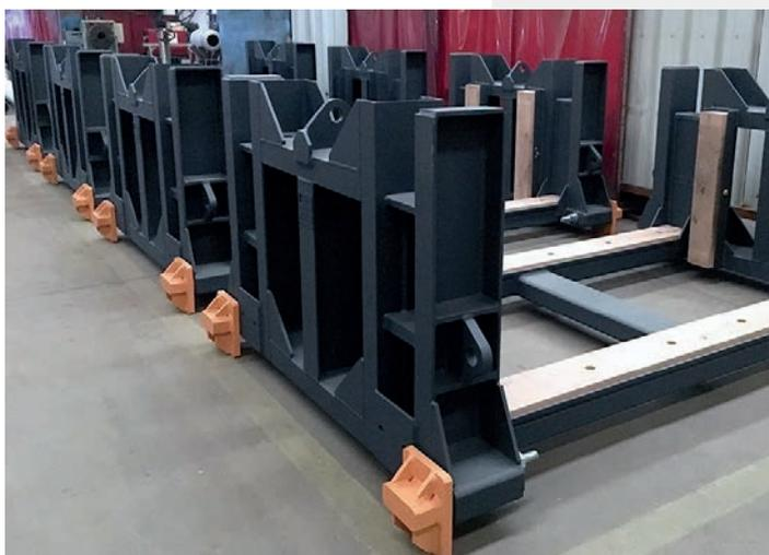
Réalisation de châssis pour transport de rail
